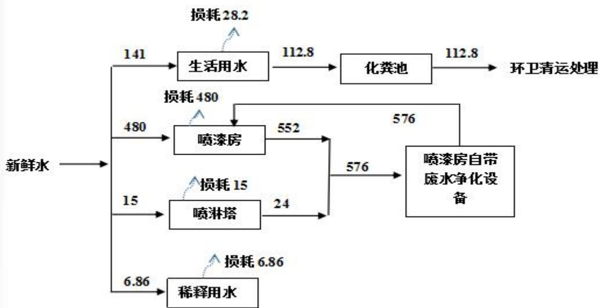
图 2-3 本项目水平衡图 (m³/a)
