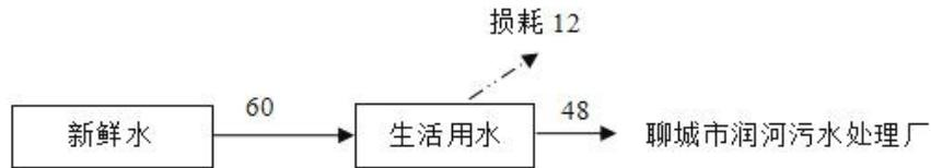
图 2-3 本项目水平衡图 (m<sup>3</sup>/a)
